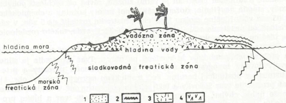
Obr. 5 Idealizovaný rez sladkovodným vadóznym prostredím, znázorňujúci rozmiestnenie zón rozpúšťania a vylučovania karbonátov 1 — zóna vylučovania, tvorba meniskového a pendantného kalcitového tmelu, 2 — tvorba kôr — „caliche“, 3 — intenzívne rozpúšťanie pod vrstvou pôdy, 4 — slabšie rozpúšťanie.
